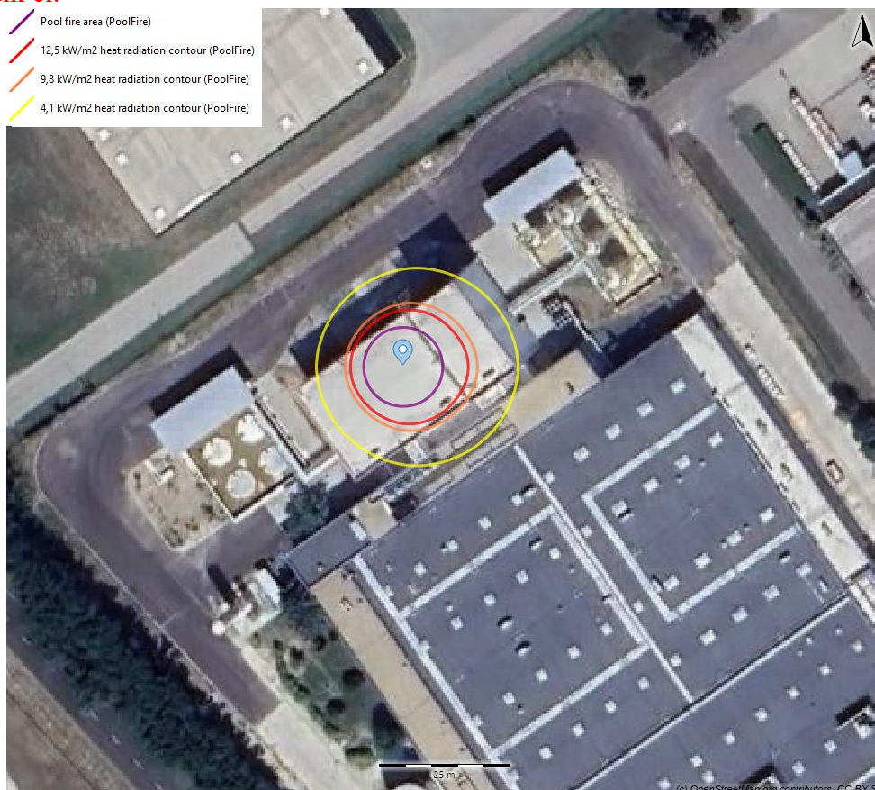
18. ábra: Veszélyes anyagot tartalmazó csővezeték törése- Tócsatűz
