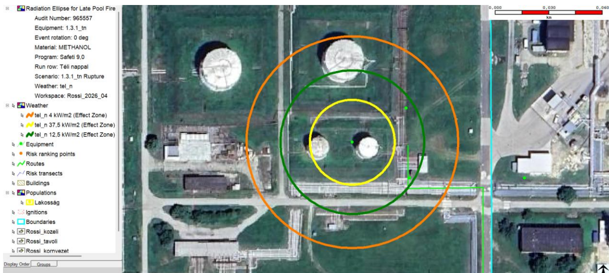
9. ábra: 1.3.1_tn baleseti esemény sor bemutatása: hőszugárzási övezetek késői tócsatűz esetén.
